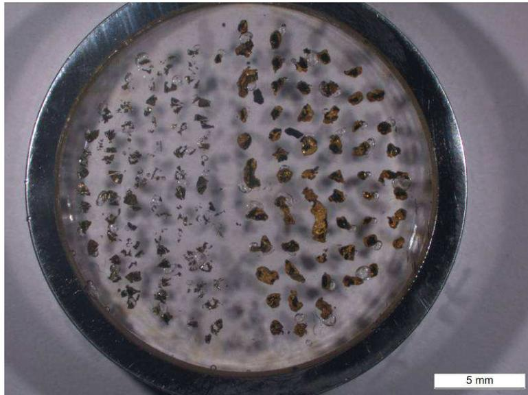
Figure 52 : Photographie de la section polie contenant l'échantillon A7bis à gauche et X4 à droite; cette photo montre bien la différence de couleur entre l'échantillon A7bis et un autre échantillon.
